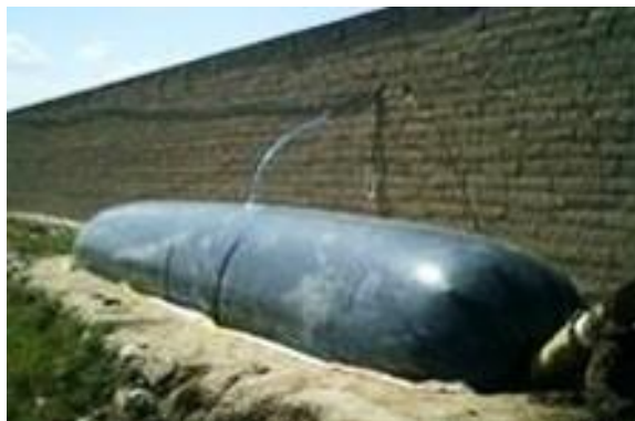
Figura 3. Biodigestor tipo balão (GONZÁLEZ, 2010).
